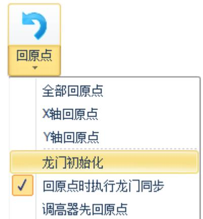
输入密码确定以后机床会回原点，之后龙门轴会向正方向运动找到两个 Z 相信号。动作完成以后，在软件下方的系统消息窗口会显示 Z 相信号的位置和两个轴的 Z 相信号差(Y2-Y1 offset)：
