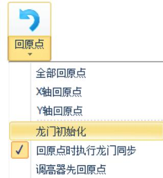
在完成龙门初始化以后勾选上“回原点时执行龙门同步”，输入密码确认。相关补偿信息显示在软件的系统消息窗口。
