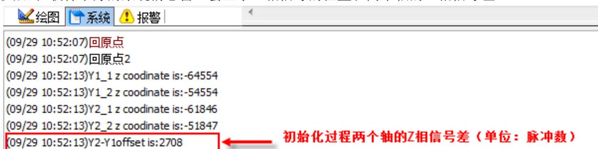
完成龙门初始化后勾选上“回原点时执行龙门同步”，输入密码确认。
