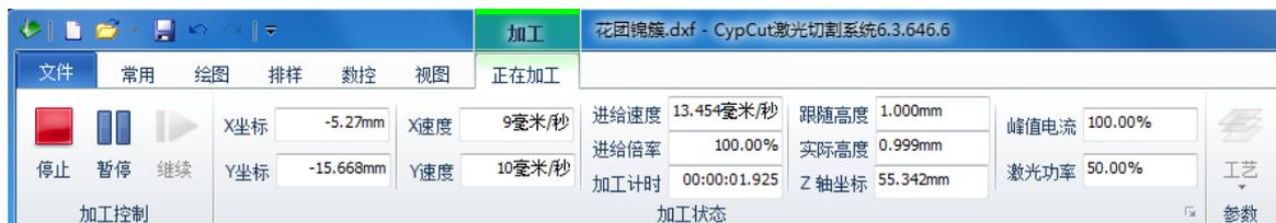
显示上图画面时，将不能切换到工具栏的其他分页，这是为了防止加工过程中修改图形，但“文件”菜单仍然可以使用。如需在加工过程中修改参数，请先暂停，然后单击界面右侧工具栏上的“工艺”按钮。
