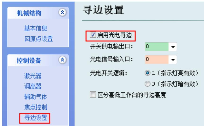
打开平台配置工具，在界面左侧的快捷选项中单击“寻边设置”进入参数设置界面，勾选启用光电寻边。
