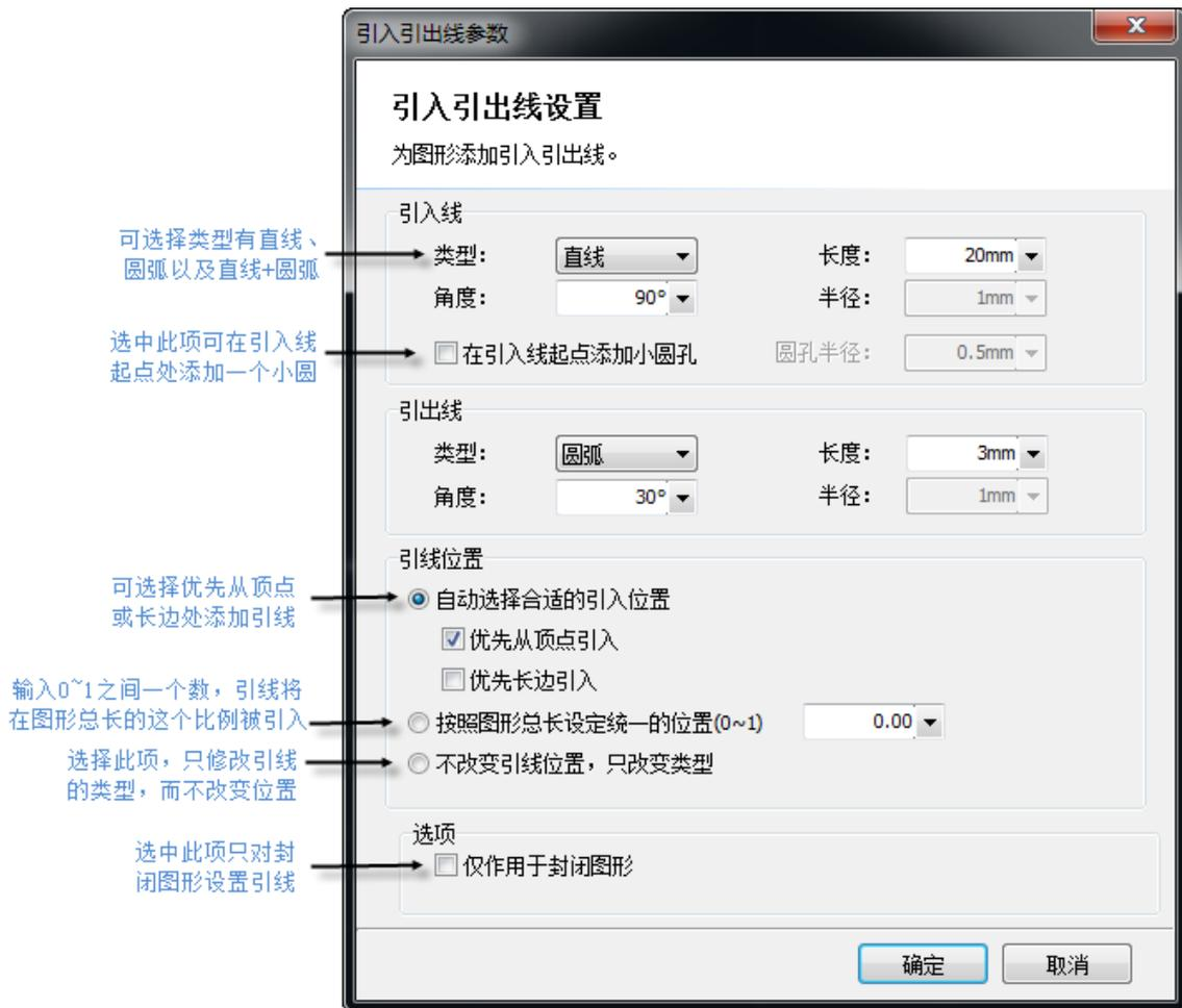
支持的引线类型包括圆弧和直线以及直线加圆弧，支持的参数包括引线类型、角度、长度和半径。您也可以选择在引入线起点加入小圆孔。
